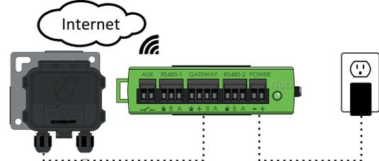
El adaptador para la conexión a la nube avanzada (CCA) requiere alimentación CA, conexión a Internet (vía cable o wifi) y conectar a uno o varios TAPs un cable de comunicación RS485.
