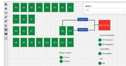
Para crear un mapa del sistema que coincida con la disposición física\*, elimine la pegatina despegable de las cubiertas de los TS4 o registre los códigos de barra en un mapa que represente la disposición física.
