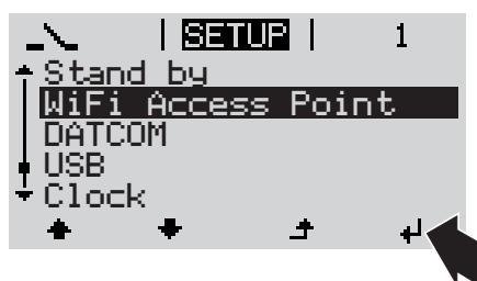
Az inverter felépíti a WLAN hozzáférési pontot. A WLAN hozzáférési pont 1 órán keresztül nyitva marad. A Fronius Datamanager 2.0 kártyán lévő IP kapcsoló a WiFi hozzáférési pont aktiválásának köszönhetően B kapcsolóállásban maradhat.
