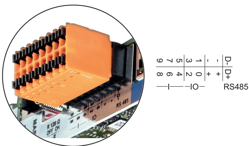
**Modbus RTU 2-vezetékes (RS485):**
