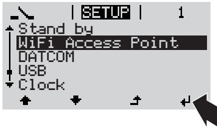
El inversor establece el punto de acceso inalámbrico. El punto de acceso inalámbrico permanece abierto durante 1 hora. El interruptor IP en el Fronius Datamanager 2.0 puede permanecer en la posición de interruptor B, gracias a la activación del punto de acceso inalámbrico.
