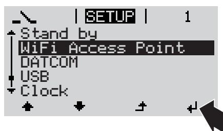
Inverter WLAN erişim noktasını kurar. WLAN erişim noktası, 1 saat açık kalır. Fronius Datamanager 2.0'daki IP şalteri, WLAN Access Point'in aktif hale getirilmesiyle B şalter konumunda kalabilir.
