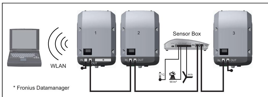
*Adathálózat 3 inverterrel és egy Fronius Sensor Box-szal:*
