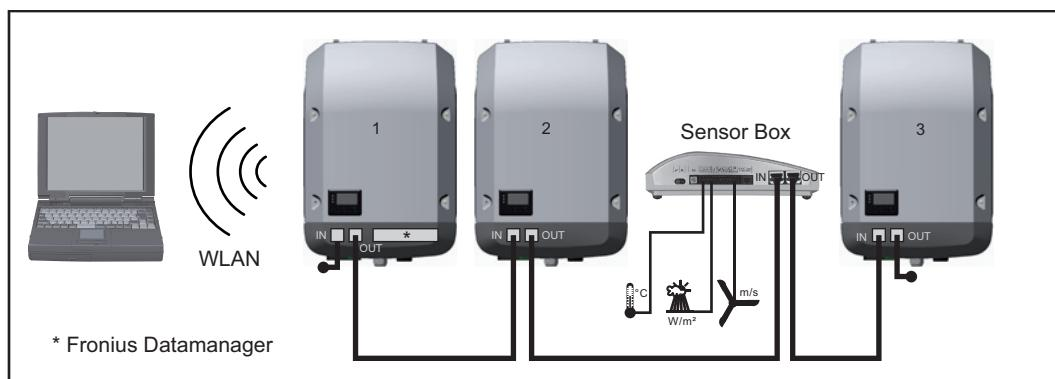
3 inverter ve bir Fronius Sensor Box'a sahip veri ağı:
