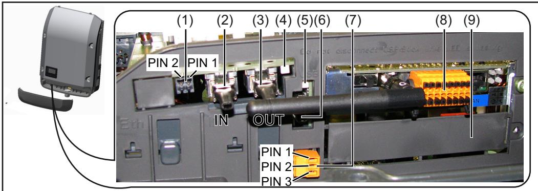
Kiviteltől függően az inverter Fronius Datamanager dugaszolható kártyával (8) szerelhető fel.
