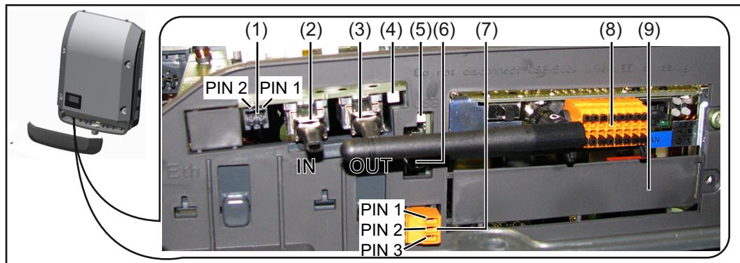
Modele göre inverter Fronius Datamanager takılabilir kart (8) ile donatılmış olabilir.
