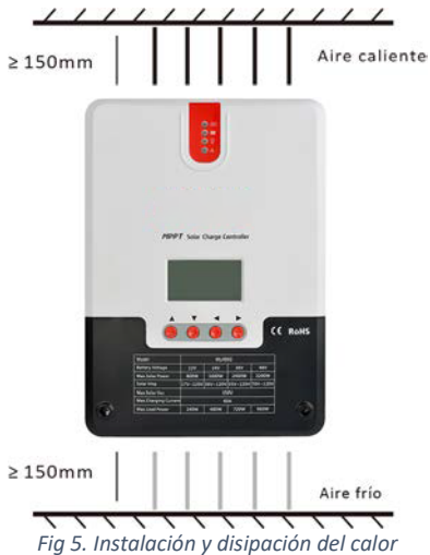
Fig 5. Instalación y disipación del calor
