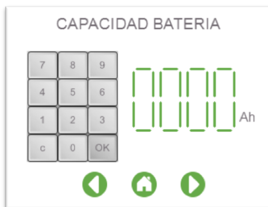
Pantalla de ajuste de la capacidad de la batería.
