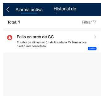
Figura 7-6 Eliminación de la alarma
