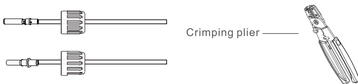
Imagen 5.4 Engarce el pin de contacto al cable
